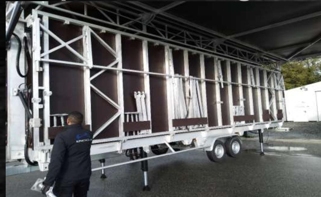
La scène est équipée de **deux échelles de piètement fabriquées d'un seul tenant en bord de plancher** pour faciliter et accélérer sa mise en œuvre, cette solution remplace l'échafaudage laborieux à trier, à positionner et à monter.
