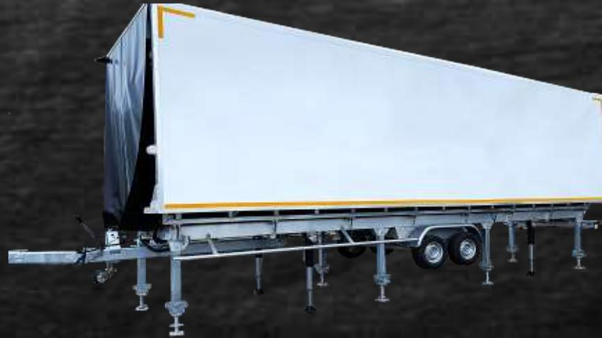
L'Alphacar® est équipée de 10 vérins hydrauliques nécessaires à la manoeuvre des ailes de plancher et de toiture ainsi qu'à la levée du toit
